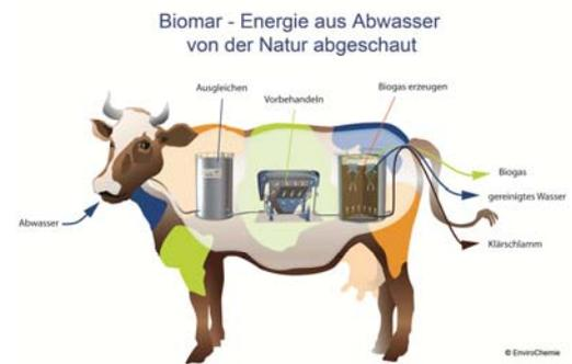
Die Funktionsweise des Bioreaktors zur Energiegewinnung aus Abwasser ist von der Natur abgeschaut. Im Kuhmagen verdauen Mikroorganismen Gras und wandeln es teilweise zu Biogas um. Die Verdauungsprodukte werden bei der Kuh in Form von Gas, Flüssigkeit und Feststoff ausgeschieden. Die Ingenieure bei EnviroChemie haben diesen Prozess in technisch reproduzierbare und an das jeweilige Abwasser anpassbare Anlagen überführt und weiterentwickelt.
