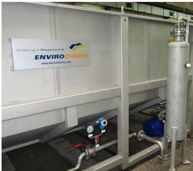
Flomar Injektorsystem (rechts im Bild) zur Erzeugung von Mikroblasen für den Flotationsprozess.
