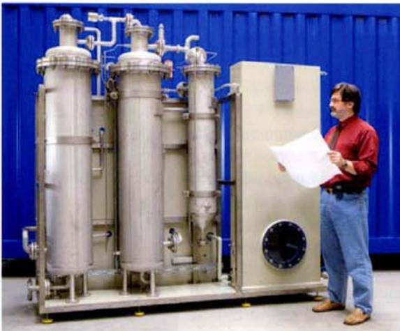
**Bild 3: Vormontierte Druckreaktoren zur Ozonisierung.**
