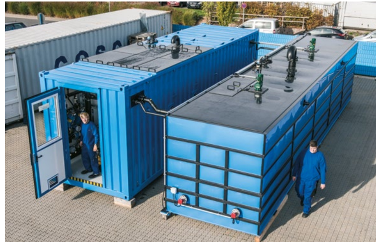
Vormontage eines modularen EnviModul-Anlagensystems mit Biomar® OMB-Membranbiologie
