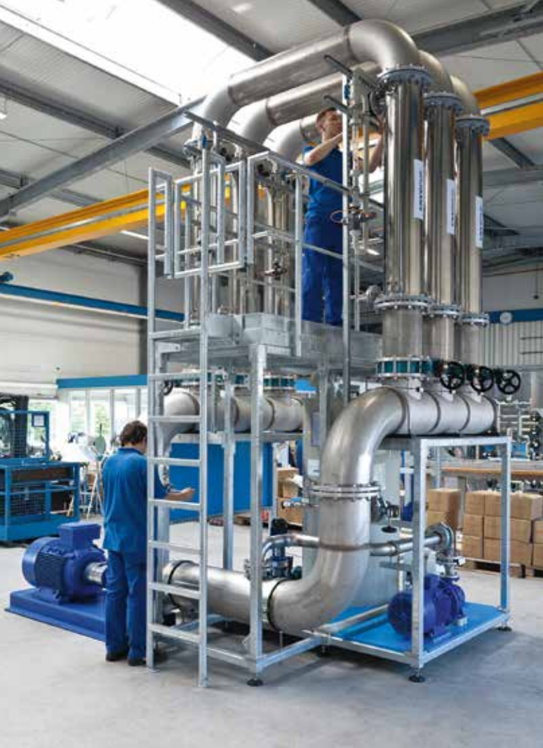
Vormontage einer Envopur® Ultrafiltrationsanlage für das Recycling von Flugzeug-Enteisungsmitteln im Werk Rossdorf.
